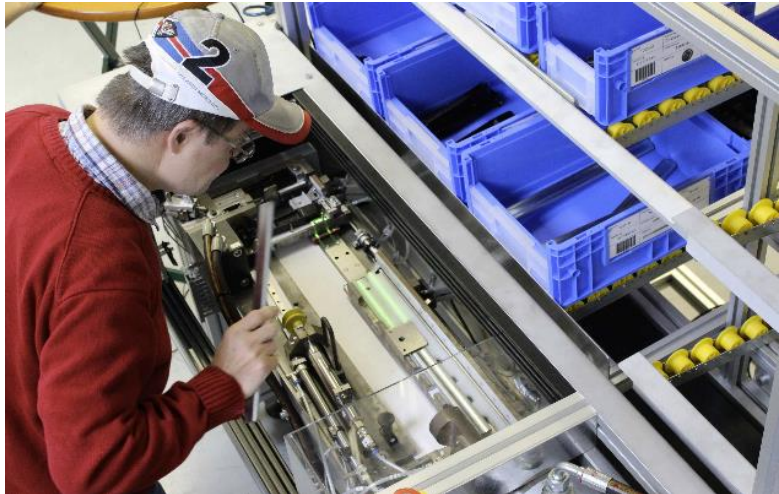
Abbildung 3: Montagearbeiter setzt eine Schraubzwinde mit Hilfe von In-Situ Feedback zusammen.
